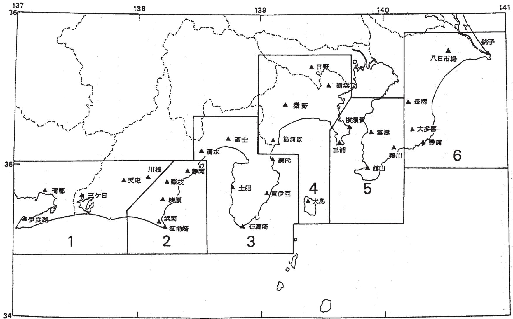
第1図 埋込式体積歪計配置図
