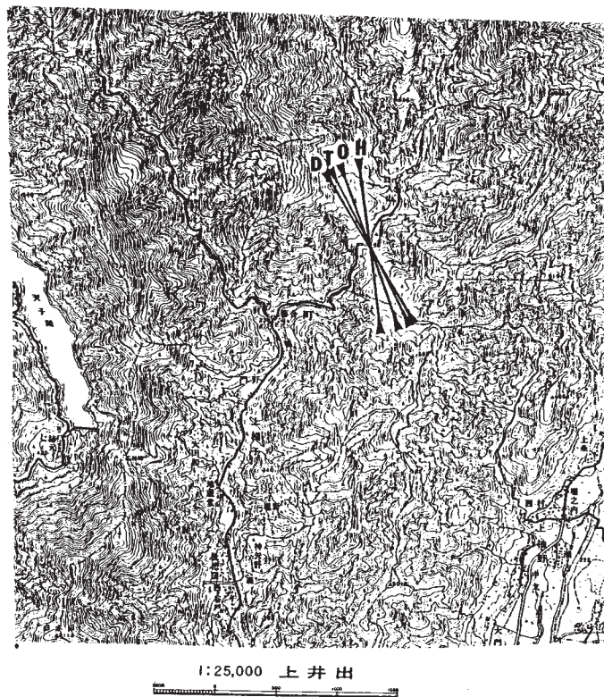
第1図 芝川町上稲子における水平最大圧縮軸方向の測定値 O : 応力解放法, H : 水圧破砕法, T : チューブ法, D : 変形率変化法
