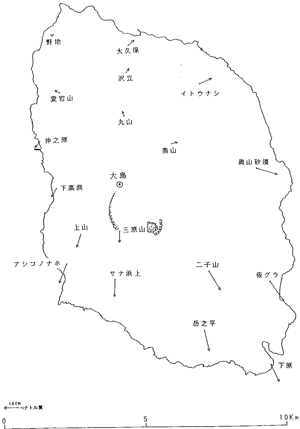
第3図 東京都公共測量(1994年)と国土地理院二次基準点測量(1988年)の比較による伊豆大島の水平変動(1):大島一等三角点に相対的な変位ベクトル
