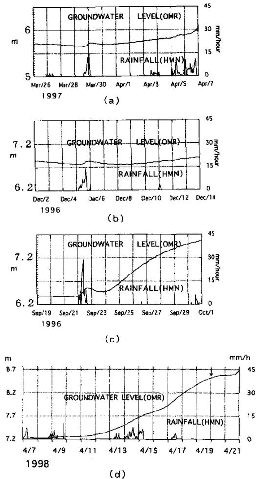
第 8 図 OMR における降雨による水位変化の典型的な例 (a, b, c) と 1998 年 4 月 7 日 ~ 21 日の水位変化
