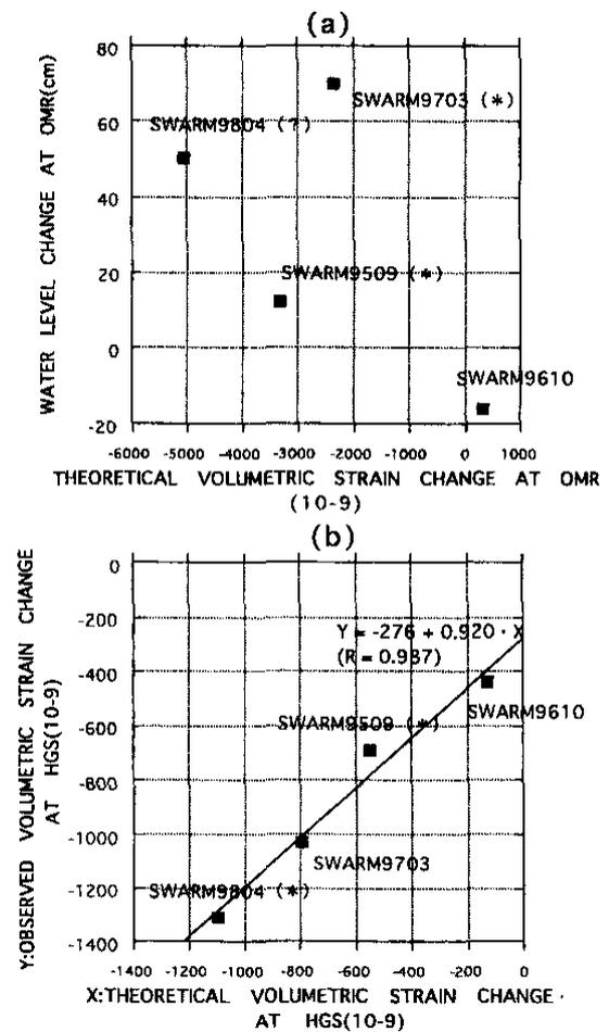
第 9 図 a. 群発地震の断層モデルより計算された大室山北観測井での群発地震後の体積歪変化 (総量) と水位変化 (総量) との比較
