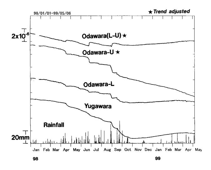
第5図 小田原2層式歪計の上下歪計出力と湯河原の歪計出力(3) 第4図の後期時間軸を拡大した。
