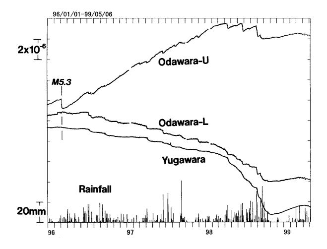
第3図 小田原2層式歪計と湯河原歪計における最近3年間の歪変化(1) 湯河原の歪は気圧・潮汐補正済み、小田原の歪は気圧補正のみ. M5.3 は平成8年(1996年)3月山梨県東部の地震(深さ20km,震央距離30km).
