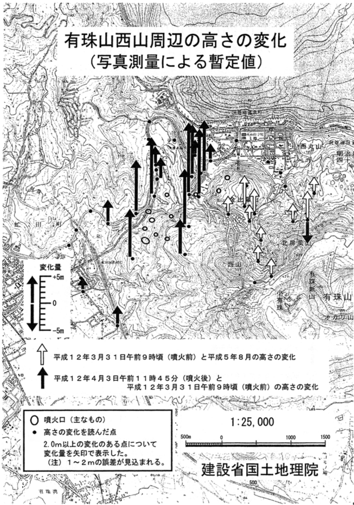
第9図 写真測量による有珠山周辺上下地殻変動(1993年8月 - 2000年3月31日)
