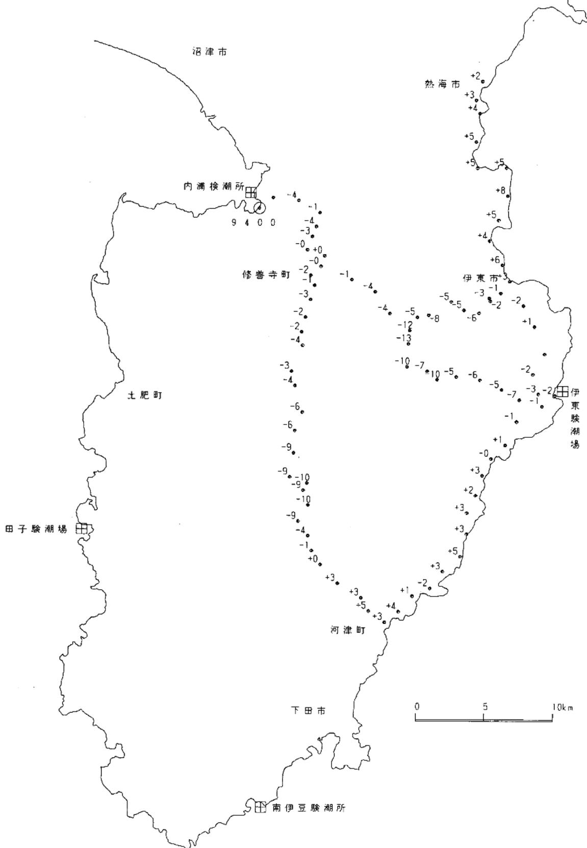
第1図(7) 水準測量による伊豆半島の上下変動(7)
