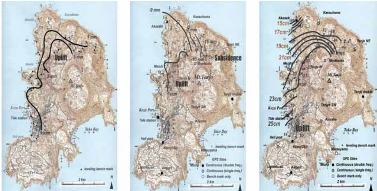
第 2 図 神津島における 2000 年 1 月以降の地殻上下変動。左)2003 年 3 月-2004 年 3 月(験潮所に対する変動)、中)2001 年 3 月-2003 年 3 月(験潮所に対する変動)、右)2000 年 1 月-2001 年 3 月(験潮所で GPS から観測された変動を加算)。2001 年 3 月以降、天上山北西山麓が相対的に隆起している。
