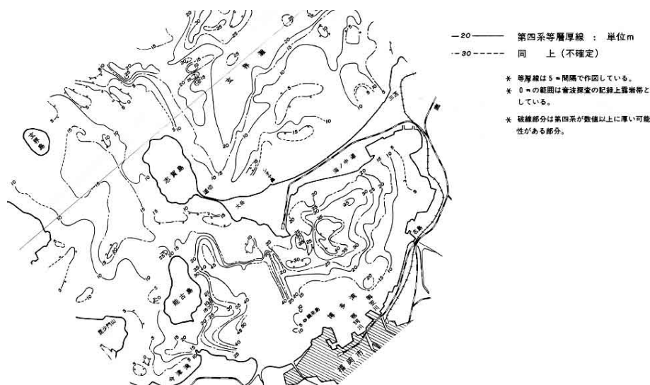
第2図 博多湾付近の第四紀堆積物の等層厚線図。地調月報 vol.26, p.609-634 (細野ほか (1975) の第7図の一部) 層厚変化から、第四紀堆積物の分布が基盤の断層の影響を受けていることが推定される。ただし、地質断層による組織地形 (古い地質構造を反映した地形) によるものなのか、活断層の変位によるものなのかは判断できない。
