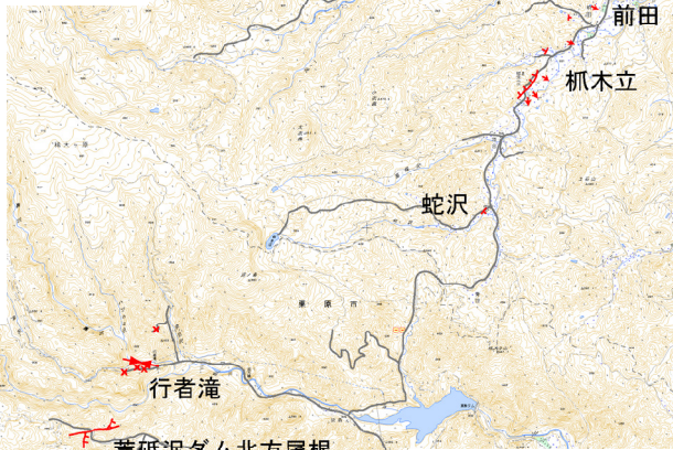
図3 爪木立における北西上がりの傾動と副断層による低断層崖の分布図 Fig.3 Map showing surface ruptures and SE-dipping tilting at Hanokidachi.
