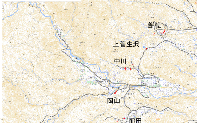
図3 爪木立における北西上がりの傾動と副断層による低断層崖の分布図 Fig.3 Map showing surface ruptures and SE-dipping tilting at Hanokidachi.
