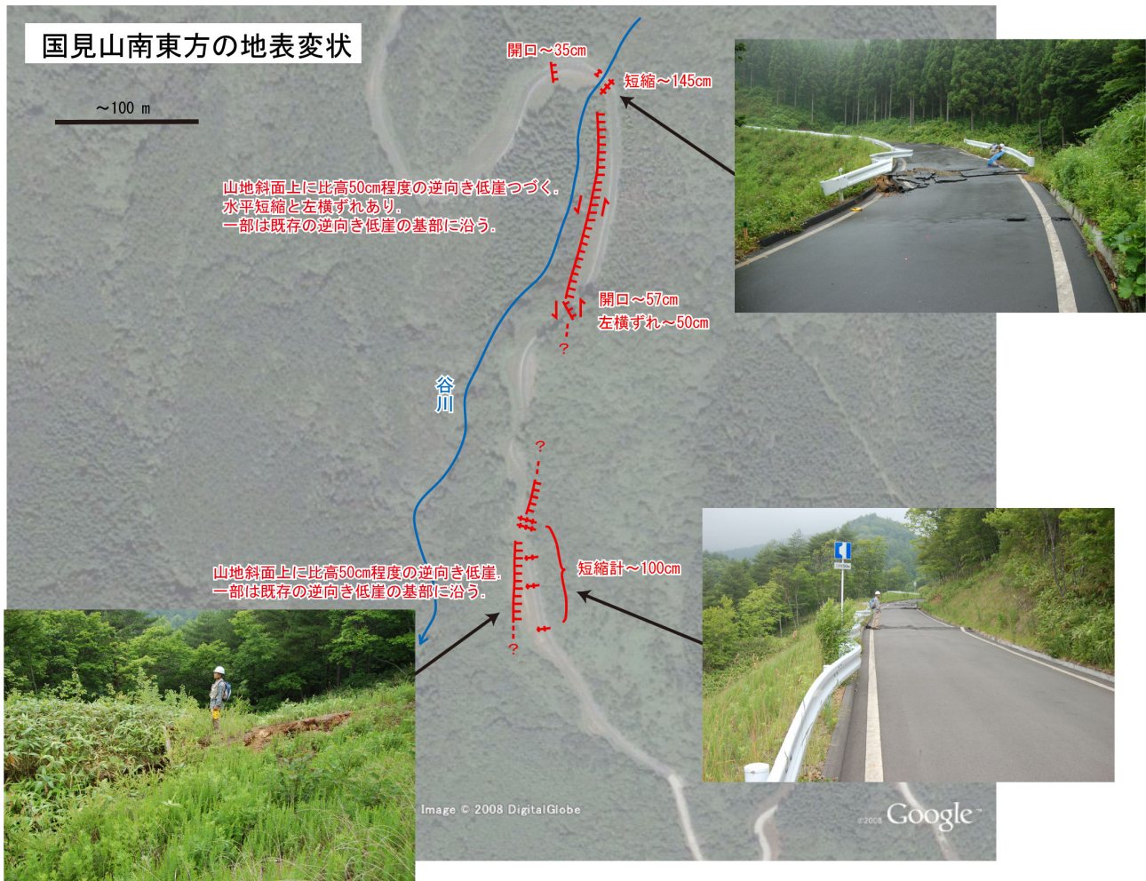
図5 国見山南東斜面で確認された地震断層の分布図 Fig. 5 Surface rupture at SE-facing slope of Mt. Kunimiyama
