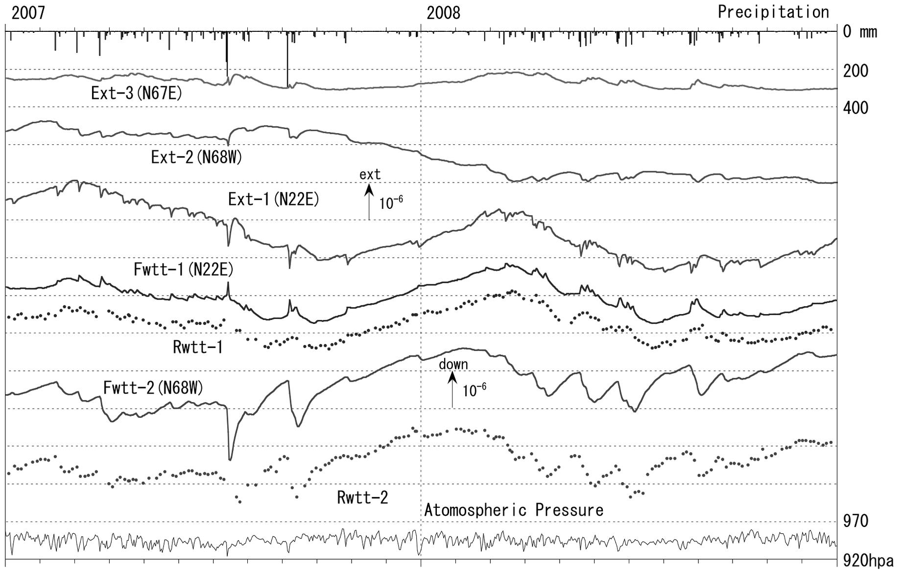
第 1 図 富士川観測所における水晶管伸縮計・水管傾斜計（実線=フロート型・黒丸=読取型）記録，
