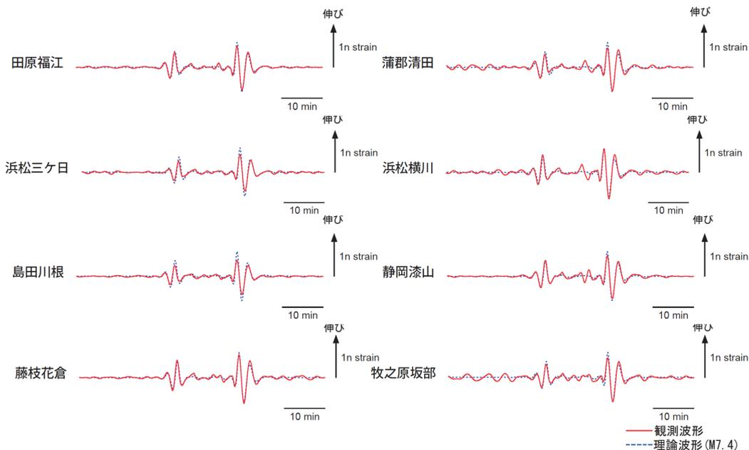
第 4 図 (g) 体積ひずみ計の記録から推定される Mw
