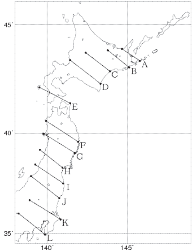
第1図 海溝と直交する方向の全国のGNSS基線. Fig.1 GNSS baselines perpendicular to the trench axes in Japan.
