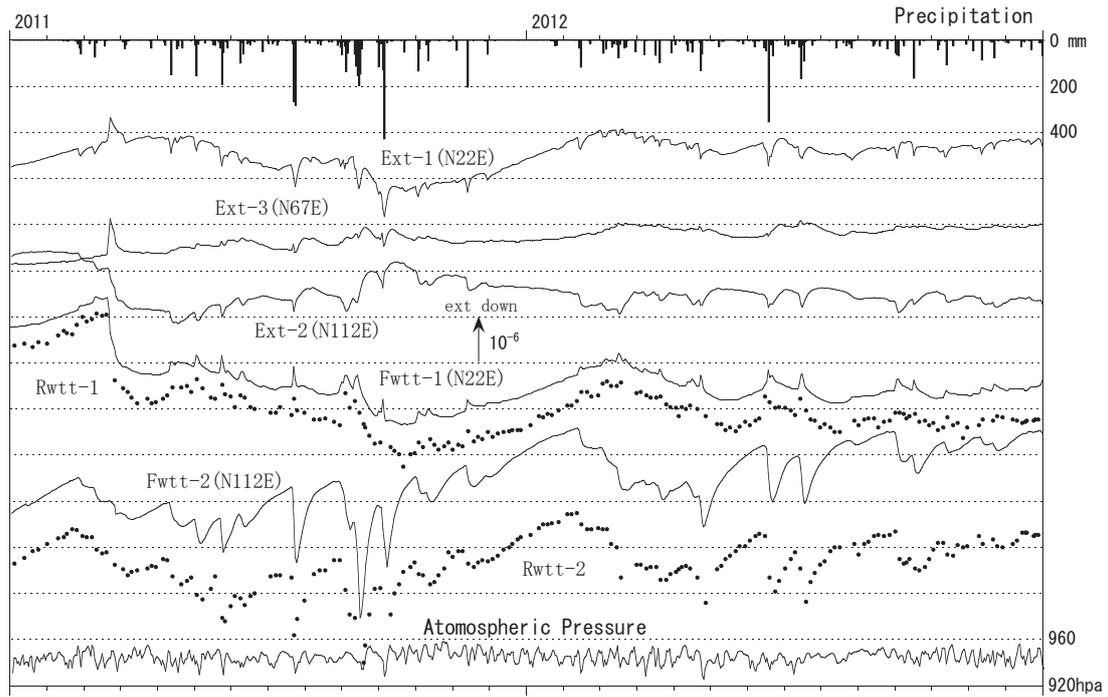
第 1 図 富士川観測所における水晶管伸縮計・水管傾斜計（実線=フロート型・黒丸=読取型）記録、気圧の日平均記録および日降雨量(2011 年, 2012 年)
