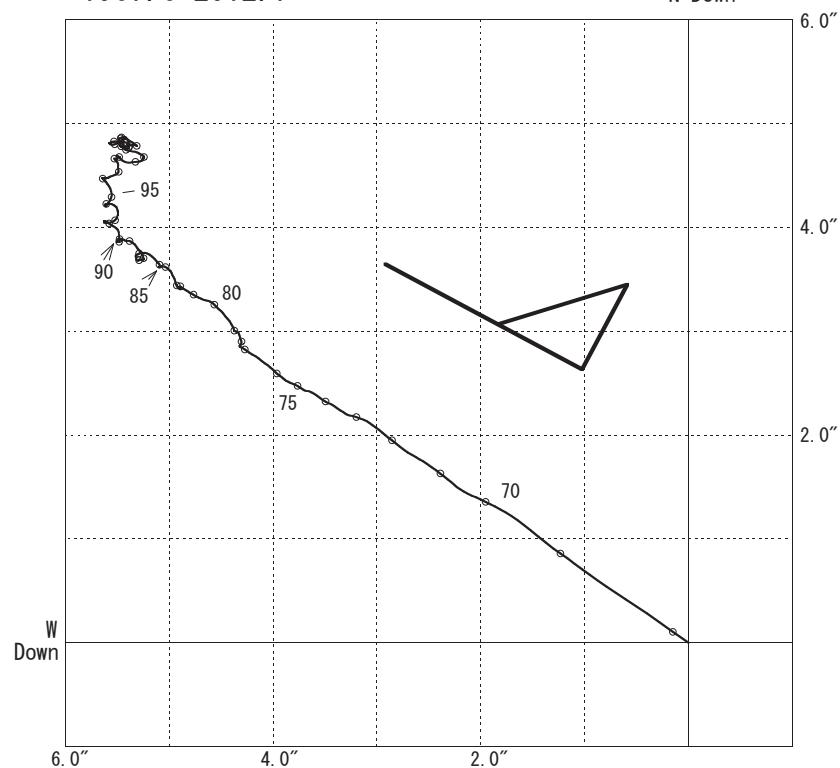
第2図 読取型水管傾斜計による永年傾動ベクトル（12ヶ月移動平均値）
