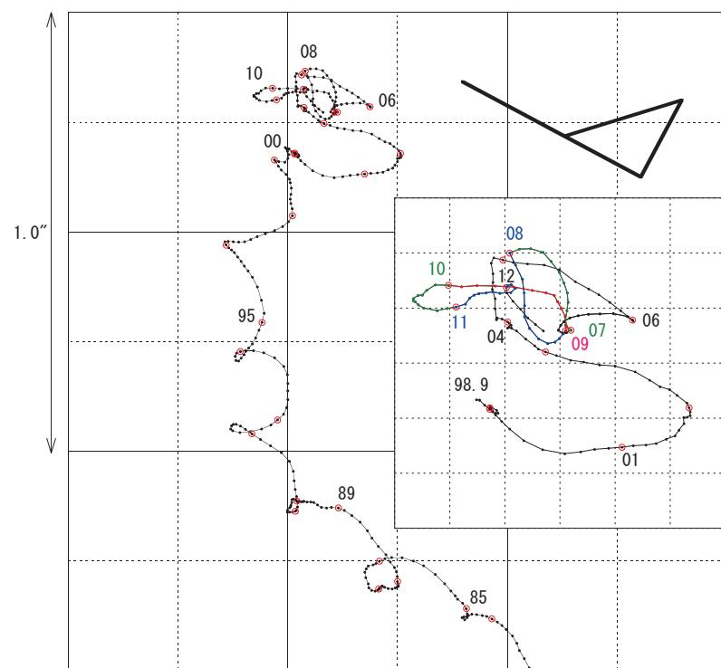
第3図 読取型水管傾斜計による永年傾動ベクトル（1983.4-2012.7）
