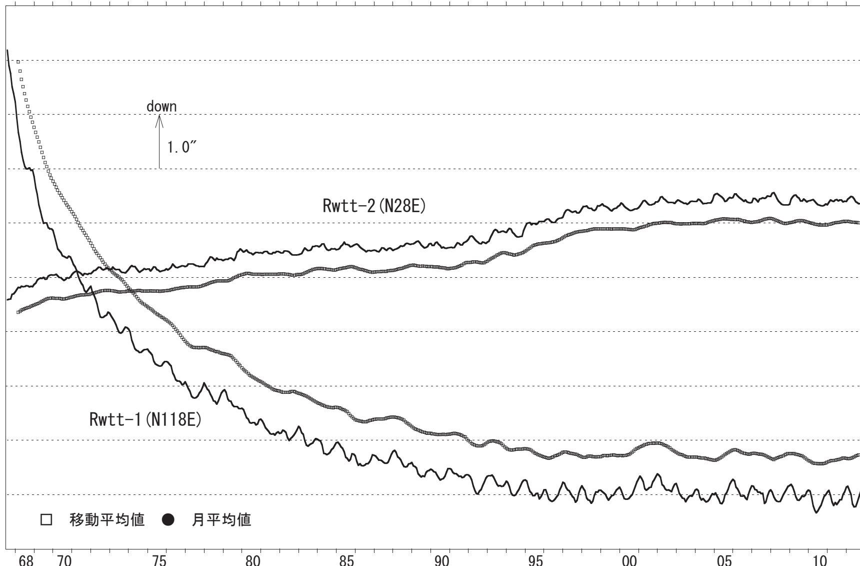
第1図 読取型水管傾斜計による累積傾斜変化（□=12ヶ月移動平均値・実線=月平均値）
