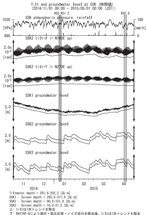
第30図 SSKにおける傾斜・地下水位観測結果(2014年11月～2015年4月)
