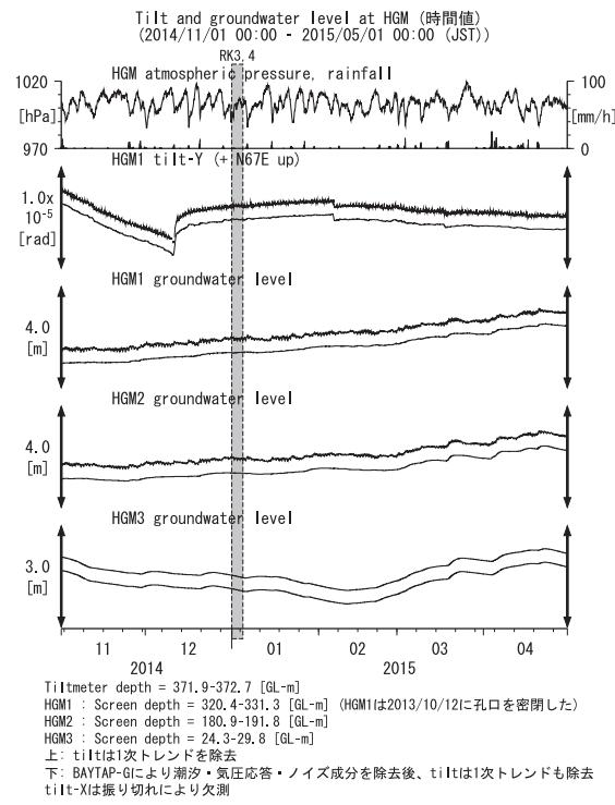
第18図 HGMにおける傾斜・地下水位観測結果(2014年11月～2015年4月)
