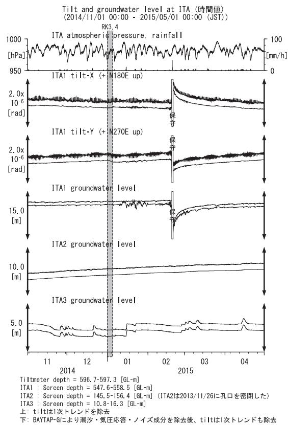
第12図 ITAにおける傾斜・地下水位観測結果(2014年11月～2015年4月)
