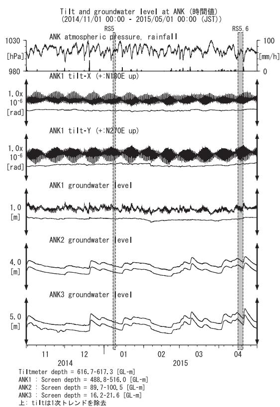
第24図 ANKにおける傾斜・地下水位観測結果(2014年11月～2015年4月)
