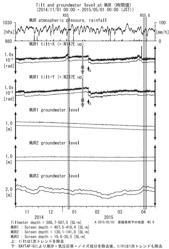
第26図 MURにおける傾斜・地下水位観測結果(2014年11月～2015年4月)
