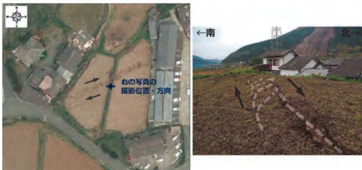
図-38a 航空写真で確認できる右横ずれによる雁行状に配列した亀裂（左）と同地点の現地写真（右：2016年4月18日撮影）。右の現地写真では、白破線で示したように、右横ずれにより、亀裂が「杉」の字のつくり部分の形に雁行配列している様子が確認できる。
