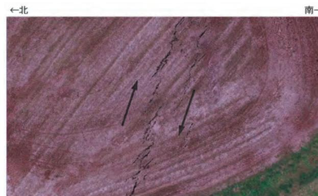
図-39 UAVで捉えた右横ずれにより雁行状に配列した亀裂（動画のキャプチャ画像）。右横ずれにより、亀裂が「杉」の字のつくり部分の形に雁行配列している様子が確認できる。
