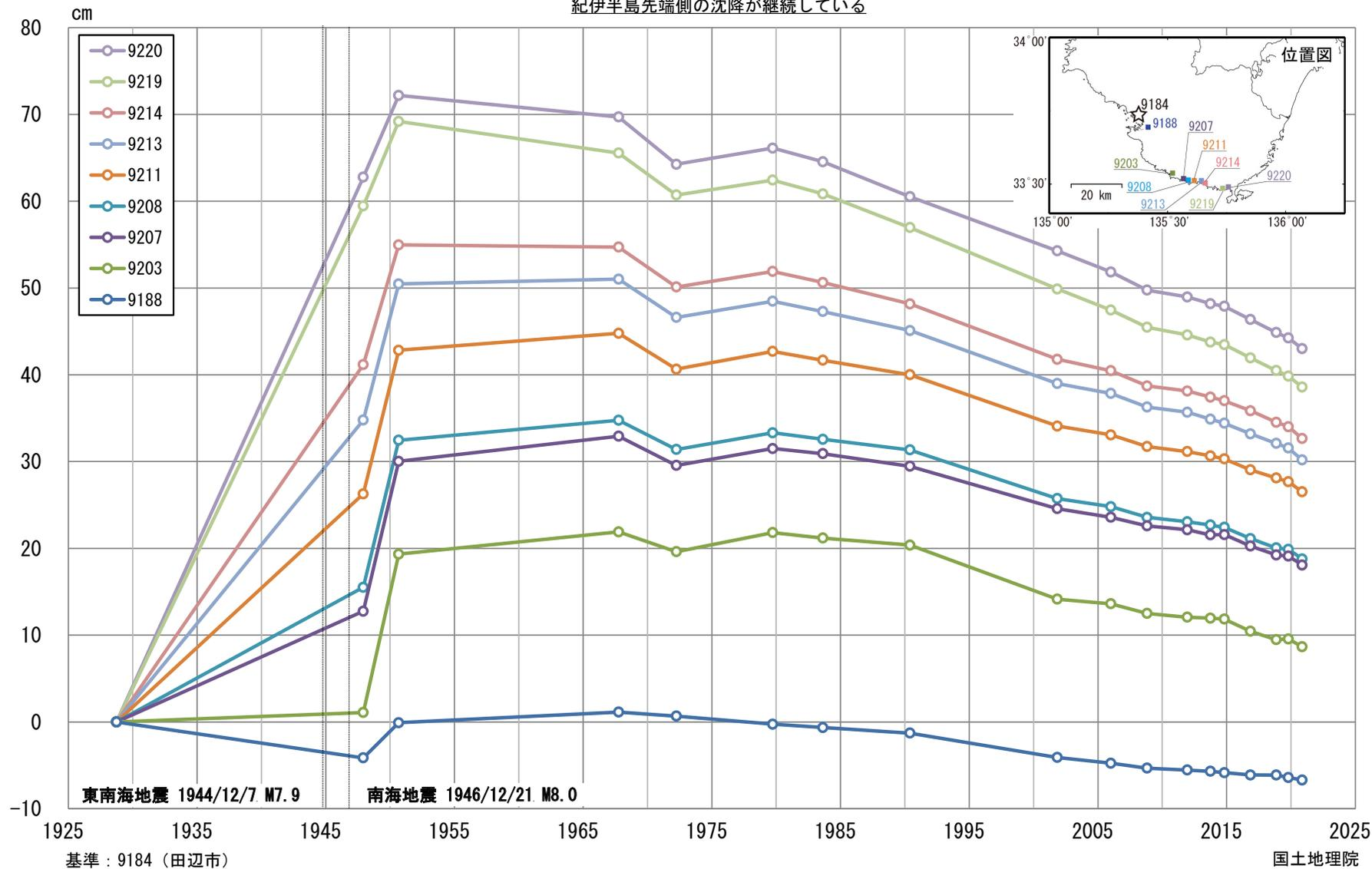
第 23 図 水準点 9148 (田辺市) を基準とした紀伊半島西側の各水準点の高さの上下変動時系列
